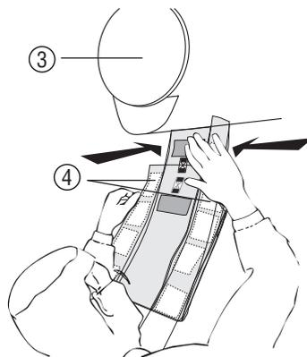
C-Bogenpaket mit Klebefläche K1 unterhalb des Bildverstärkers (3) festkleben. Schutzpapier der Klebeflächen K2 (4) abziehen und an den Seiten des C-Bogens festkleben.
