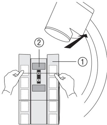
Mit beiden Händen das C-Bogen-Paket (1) mittig nehmen, das blaue Schutzpapier von der Klebefläche K1 (2) lösen.
