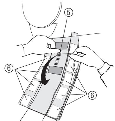
Pfeiletikett 1 (5) öffnen und Folienteil nach unten klappen. Schutzpapier von den Klebeflächen K3 (6) abziehen und an den Seiten des C-Bogens festkleben.
