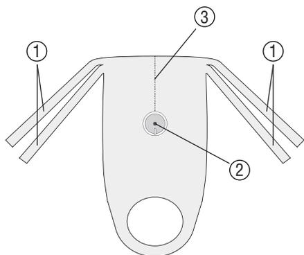
Il sacchetto di raccolta TUR viene dispiegato in modo che i lacci di fissaggio (1) siano accessibili. L'ugello di scarico (2) è rivolto verso il basso (vedere anche la figura 5), la linea di saldatura (3) verso il tavolo operatorio.
