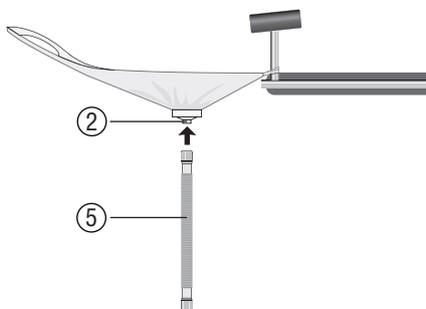
Il tubo flessibile (5) (venduto separatamente) viene ora innestato nell'ugello di scarico (3) del sacchetto di raccolta.
