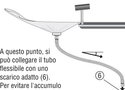
A questo punto, si può collegare il tubo flessibile con uno scarico adatto (6). Per evitare l'accumulo di liquido all'interno del tubo di scarico, è necessario garantire una pendenza costante all'interno del tubo.
